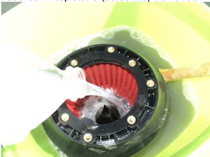
*Mettre le filtre a air dans une bassine et faire couler le liquide de l'intérieure vers l'extérieure.*
