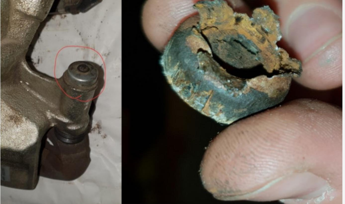
Un 1er bon nettoyage à la brosse de fer et passage dans bain de vinaigre + bicarbonate de soude.
