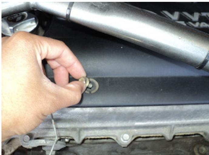
*Commencer par débranché le Négatif de la batterie et démonter le cache plastique couvre culasse.*
