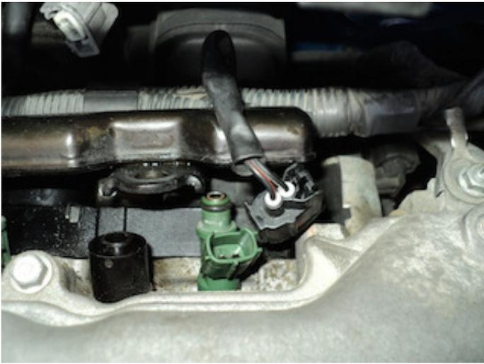
*Insérer les nouveaux injecteurs dans les puits du bloc.*
