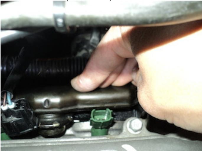
*Pousser légèrement la rampe d'injection vers le bas afin que les joints torique et les amortisseurs d'injecteurs entre en contact et étanchéifient le tout.*
