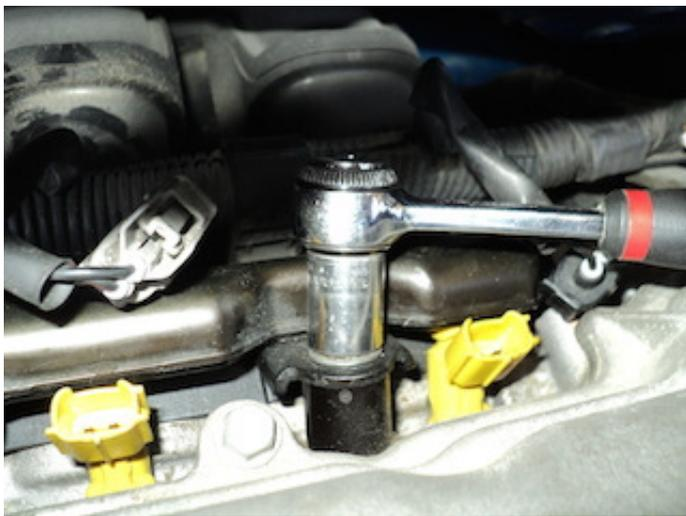
*Dévisser la rampe d'injection avec le cliquet et la douille de 12.
